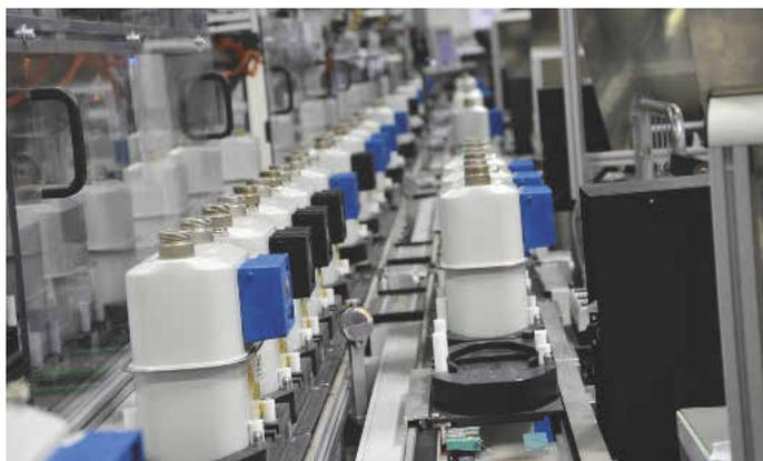
An der Anlage von Stein montieren Mitarbeiter elektronische Zählwerke an die Gaszähler
