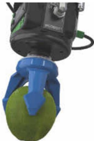
Piab präsentiert das neue, weiche Greifwerkzeug PiSoftgrip, das speziell für die Lebensmittelindustrie entwickelt wurde. Der vakuumbasierte, weiche Greifer ist geeignet, empfindliche und leichte Objekte mit unregelmäßigen Formen und/oder ungewöhn-
