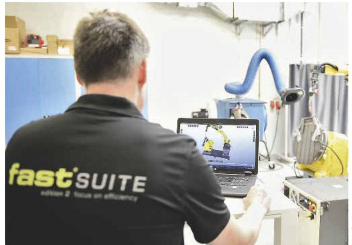
Mit der Software Fastsuite können Roboter offline programmiert werden
