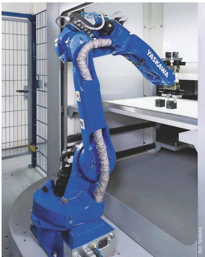
Der Roboter ist auf einem stabilen Sockel direkt an der Zelle angeordnet. Mit seiner großen Reichweite von über 1,7 m erreicht er alle Arbeitspositionen problemlos
