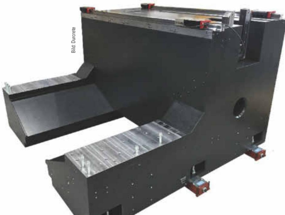
Vertikalfräse aus Nanodur-Beton, produziert in China
