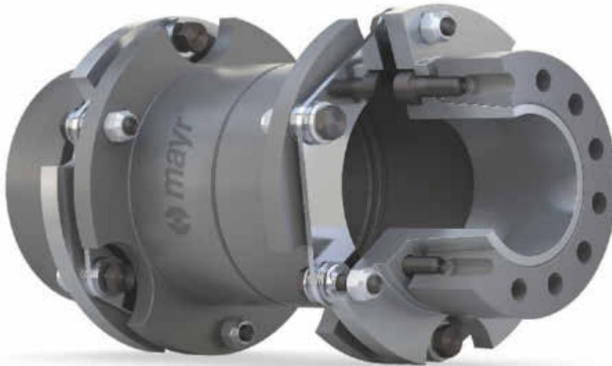
Die leistungsstarken und robusten Roba-DS-Lamellenpaketkupplungen übertragen das Drehmoment spielfrei und äußerst drehsteif. Sie sind kompakt und leistungsdicht und gleichen vorhandenen radialen, axialen und winkligen Wellenversatz aus
