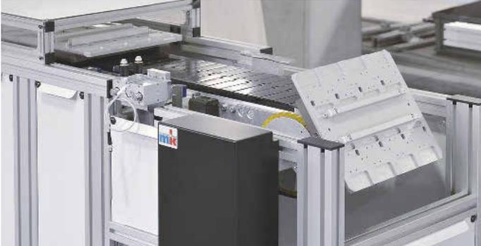
SPU 2040. Insbesondere beim Verketteten mehrerer Arbeitsstationen mit unterschiedlichen Takt- oder Umrüstzeiten ermöglicht dieses System das dynamische Puffern und Vereinzeln von Werkstückträgern. Zudem werden die leeren Werkstückträger nach der Werkstückentnahme automatisch unterhalb der Transportebene zurück gefördert und am Anfang der Transportstrecke wieder auf die obere Transportebene bewegt und stehen zur erneuten Werkstückaufnahme bereit.
