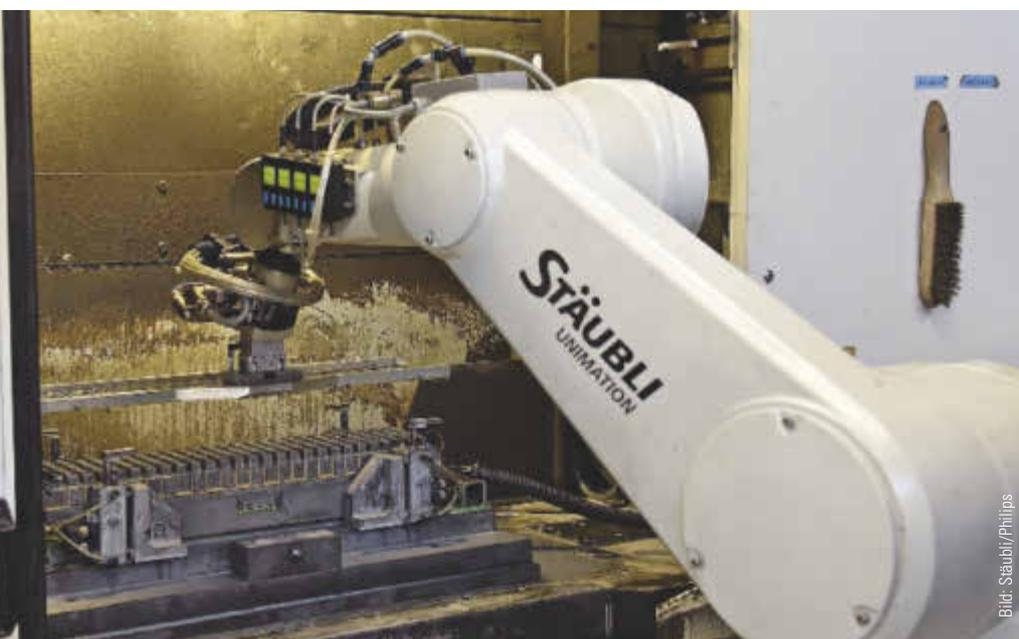
Aufgrund seiner voll gekapselten Bauweise kommt der Stäubli-Sechssachser mit den Bedingungen innerhalb der Schleifmaschine problemlos zurecht
