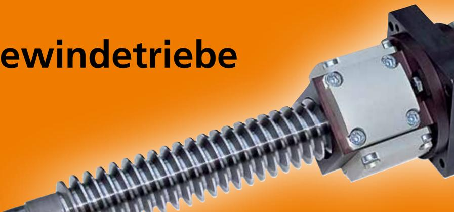
Hydrostatische Gewindetriebe (HGT) überzeugen durch eine geringe Positionstreibereite, sind hoch belastbar, arbeiten verschleißfrei und sind Linearmotoren zudem durch weit geringere Betriebskosten überlegen. Gute Gründe also, bei Linearantrieben für spanende und umformende Werkzeugmaschinen auf den HGT zu setzen.
